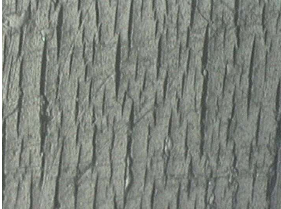
Figura 5.10. Polipropileno homopolímero tras 300 horas de exposición (200 x)
