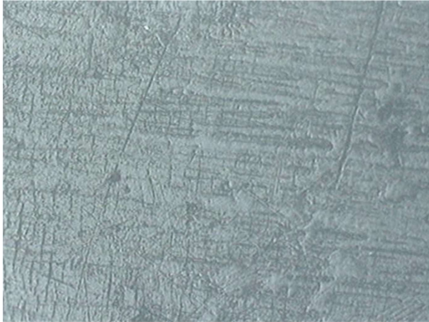
Figura 5.6. PP Homopolímero después de 100 horas de exposición (200 x)
