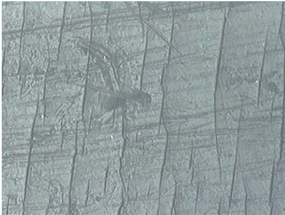
Figura 5.8. PP Homopolímero tras 200 h de exposición ( 200 x )
