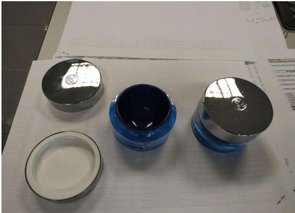
Figura 1.15. Tapa de ABS metalizada, interior de POM y disco de PS, cubilete de PP pegado en el interior del tarro de PMMA.
