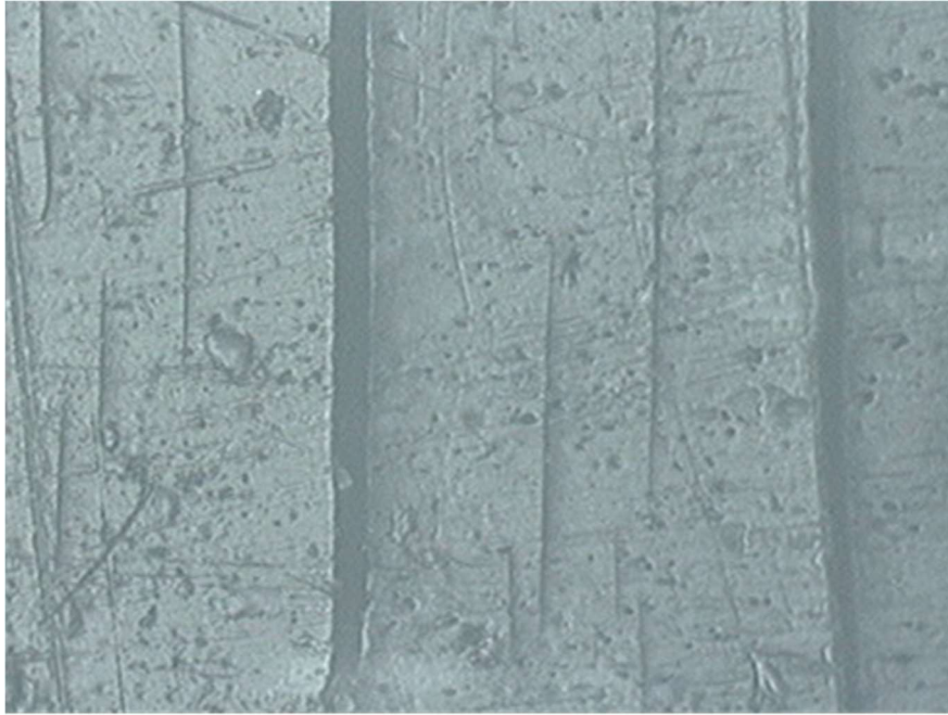
Figura 5.12. PP + 10% Santoprene después de 300 horas de exposición (200 x)
