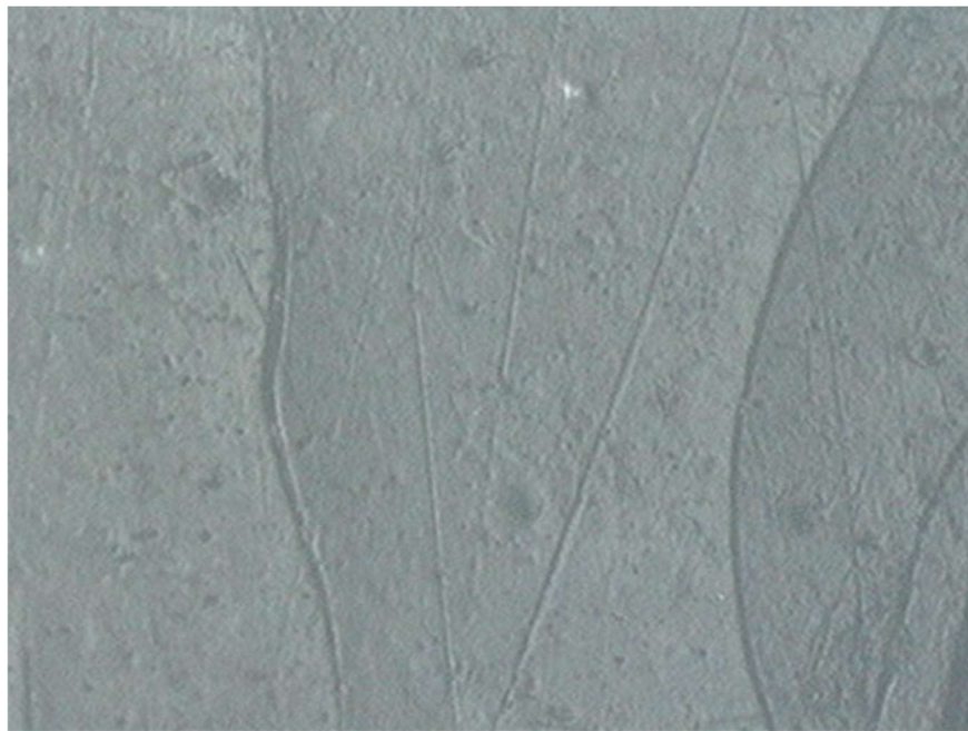
Figura 5.11. PP + 10% Santoprene después de 200 horas de exposición (200 x)
