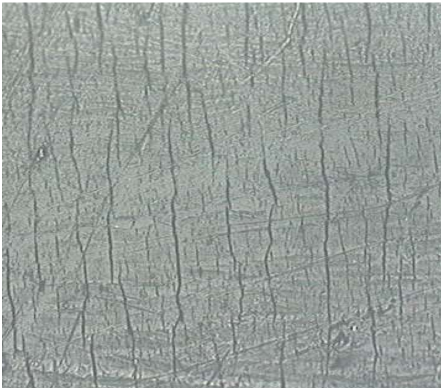
Figura 5.7. PP Homopolímero tras 160 h de exposición (200 x)
