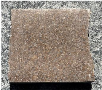
Figura 15: Superficie después de aplicar el P120
