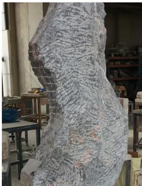
**Figura 3:** Marcas generadas en la aplicación del martillo neumático
