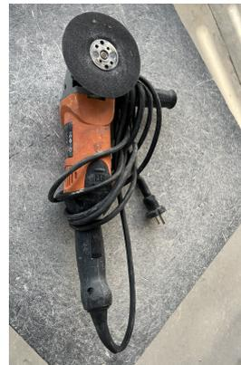
**Figura 6:** Radial con discos abrasivos
