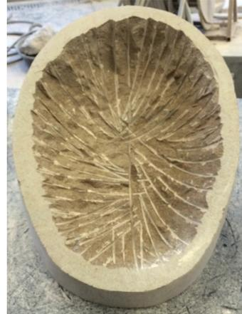
**Figura 2:** Marcas generadas en el desbaste por paredes
