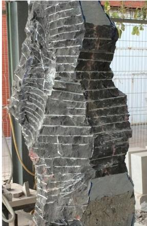
**Figura 1:** Marcas generadas en el desbaste por paredes
