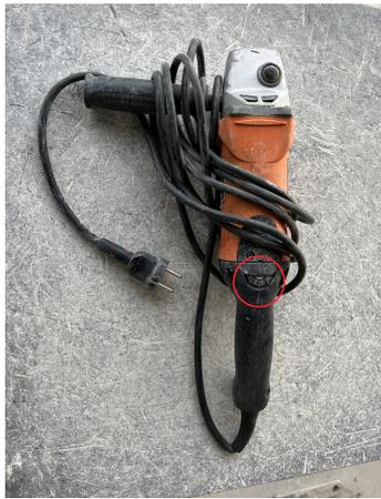
Figura 7: Radial con regulador de revoluciones
