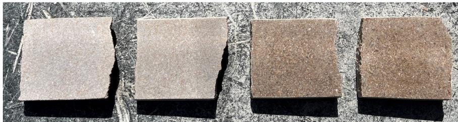
Figura 17: Superficie después de aplicar el P120
