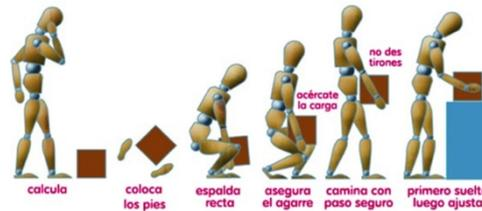
**Figura 16:** Secuencia para el movimiento de una carga pesada
