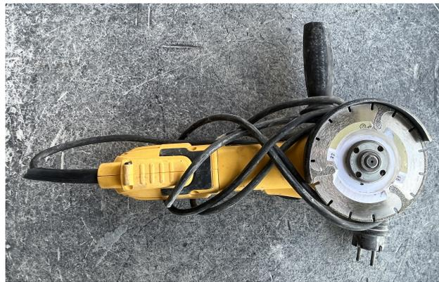
Figura 2: Radial con disco diamantado
