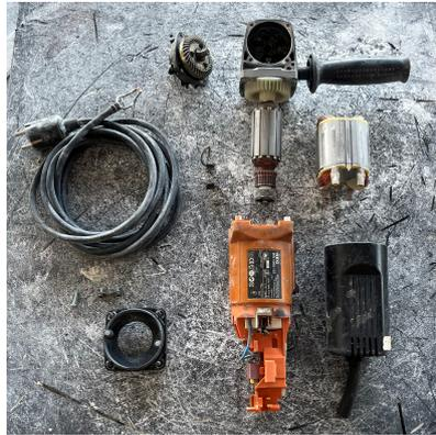
**Figura 3:** Elementos que componen la radial
