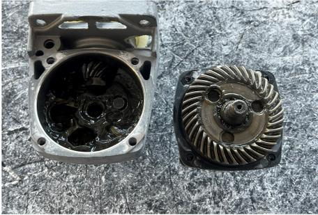
Figura 8: Engranaje helicoidal
