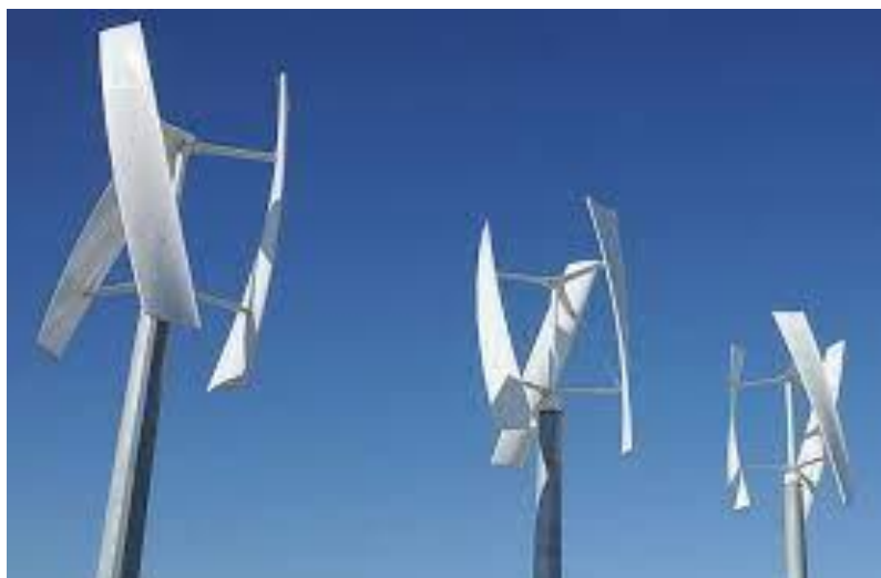
Ilustración 15: Aerogeneradores de eje vertical (Totalenergies, 04)
