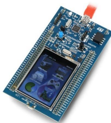
Figura 16. Placa de desarrollo STM32F429I-DISC1 con microcontrolador STM32F429ZIT6 [21].
