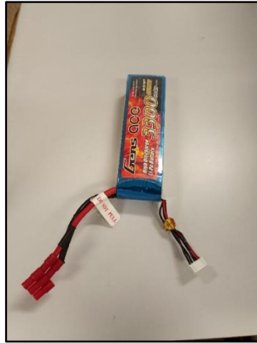
Figura 13. Batería LiPo 4S1P empleada (14.8 V de tensión nominal y 3300 mA/h).
