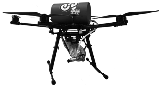
Figura 4. Dron híbrido con batería y pila de combustible de la marca H2DronEnergy [7].
