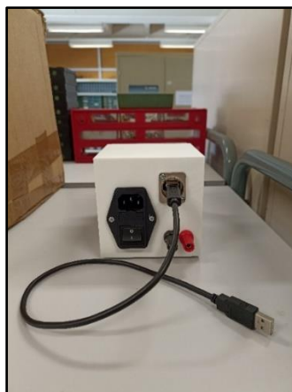
Figura 14. Carga electrónica empleada para simular el comportamiento del dron.
