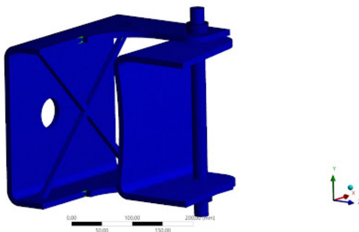
Figura 4.7: Deformación total de la bisagra
