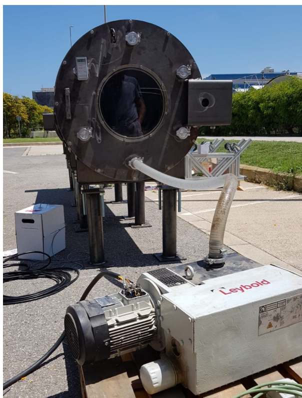
Figura 6.1: Primer ensayo prueba de vacío
