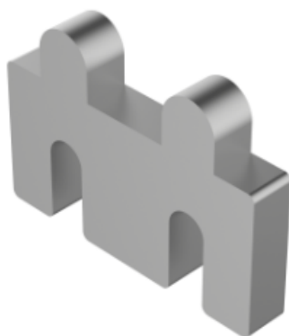
Figura 4.3: Vista de las pletinas del sistema de anclaje del perfil lateral
