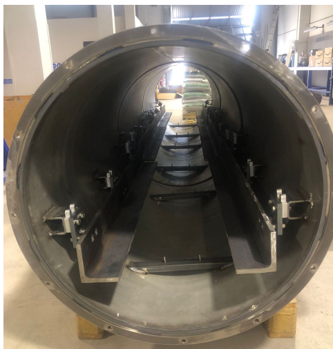
Figura 5.3: Brida punteada en el tubo
