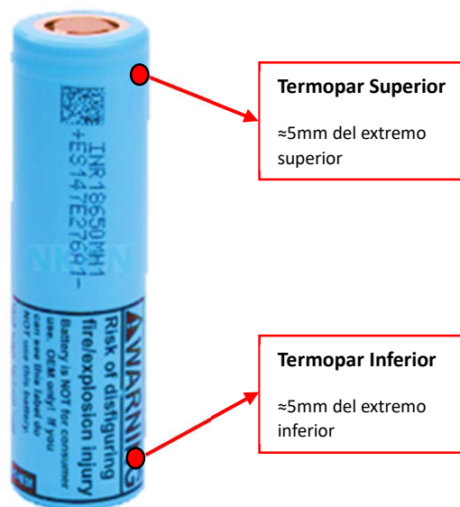
Figura 20. Esquema de montaje de termopares
