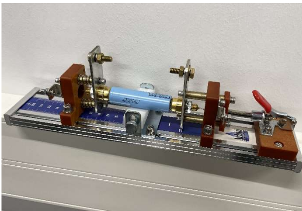
Figura 11. Soporte de baterías
