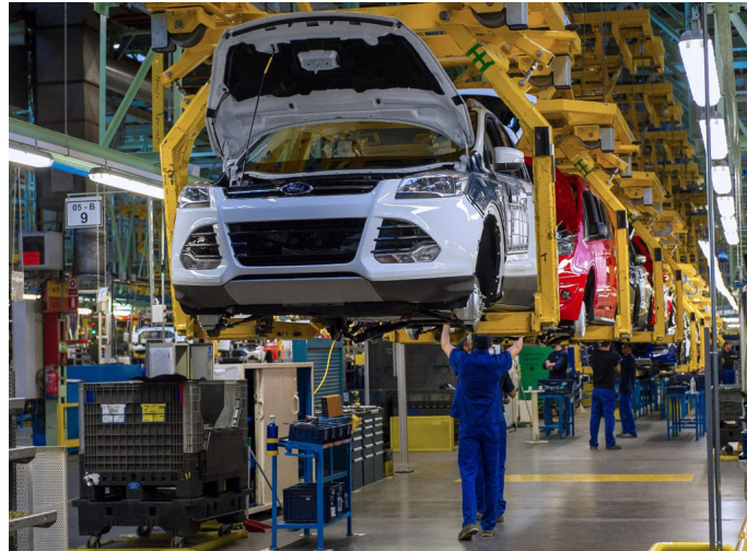
Figura 2.2: Coche desplazandse por la electrovía en la línea de Chasis
