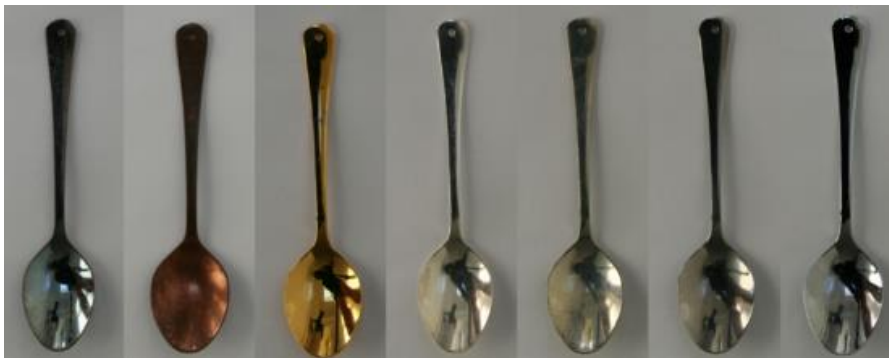
Figura 6. Cucharas de acero inoxidable galvanizadas de los distintos metales utilizadas en el estudio
