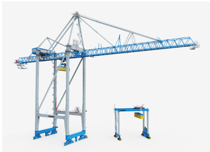
Figura 3.1.11: Grúa de muelle o Quay Crane en la izquierda y grúa de almacenamiento automático o Yard Crane en la derecha
