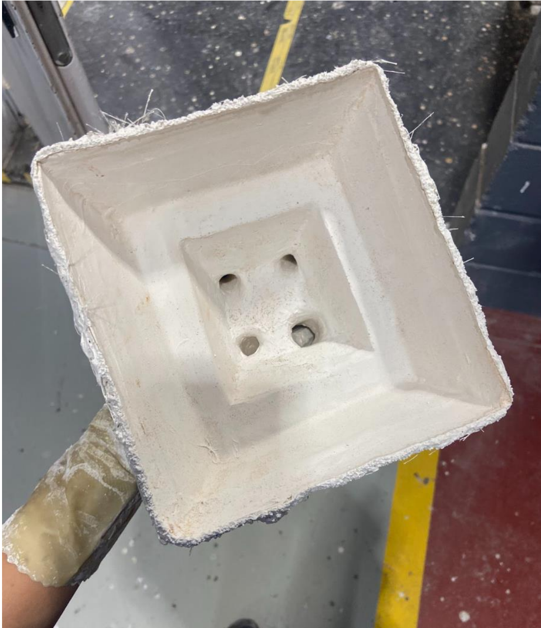
Fig. 39. Molde cerámico sin modelo de cera.
