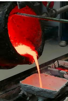
Fig. 42. Vertido de metal fundido.
