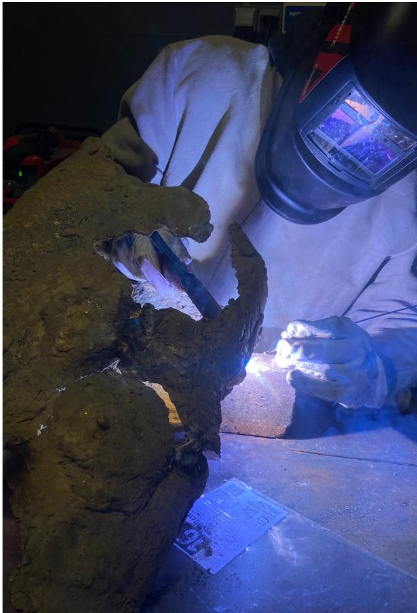
Fig. 45. Paco Benavent realizando la soldadura TIG.
