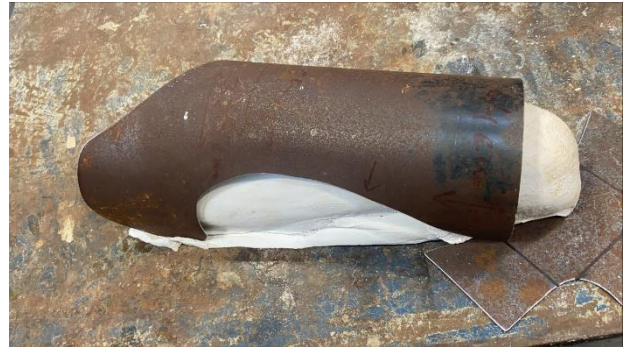
Fig. 16. Pieza sobre molde de escayola.
