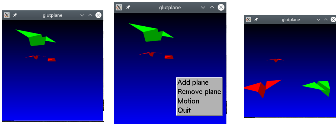
Figura 3: Salida de la versión original de glutplane : de izquierda a derecha, escena inicial, menú asociado al ratón desplegado y objetos en movimiento tras escoger “Motion” en el menú.
