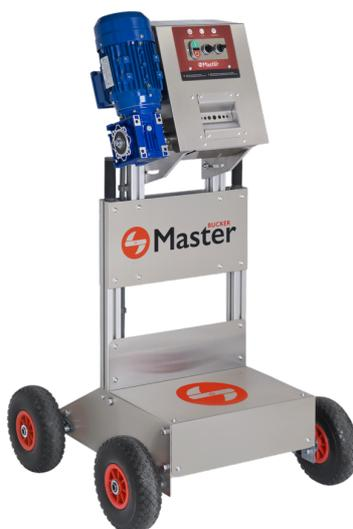
**Figura 11.3:** Máquina para la eliminación de tallos
