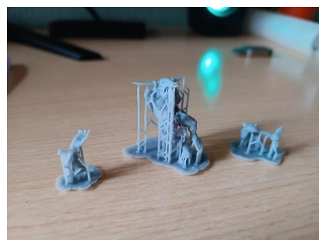
Fig. 34. Partes del modelo impreso con soportes.
