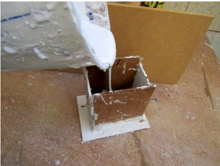
Fig. 39. Vertido de la silicona en el encofrado.
