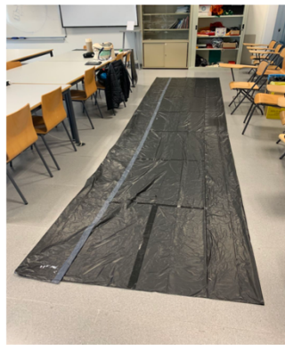
Se generaron los paneles con doble capa de bolsas y reforzando las uniones del rollo de bolsas con cinta aislante.
