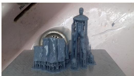
Fig. 74. Dejamos a secar la pieza para que se retiren los restos de resina líquida del tanque.
