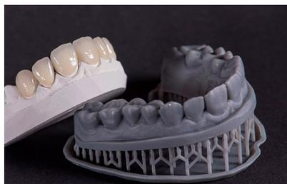
Fig. 13. Impresión en 3D de la réplica de una dentadura.
