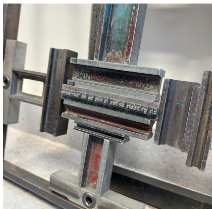
Figura 12. Text a la branca preparat per la impressió.
