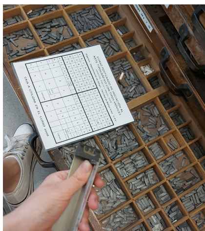
Figura 11. Composició de text amb lletres de plom.
