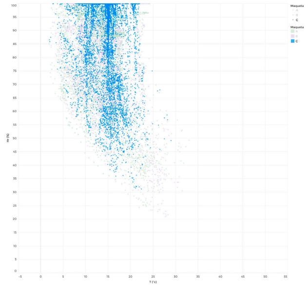
Figura 6.43. Diagrama de dispersión con la distribución de los datos por humedad relativa (%) y temperatura (°C) por maqueta para el mes de noviembre.
