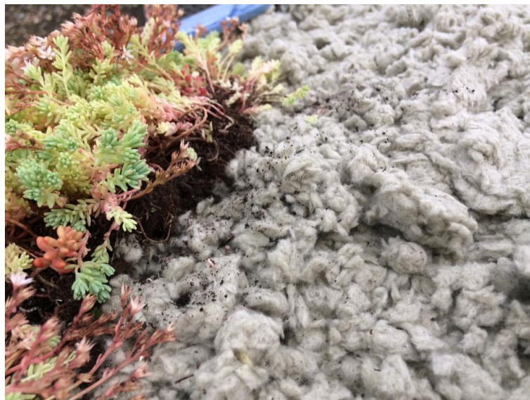
Figura 4.16. Capa drenante y sustrato realizadas con lana de roca.
