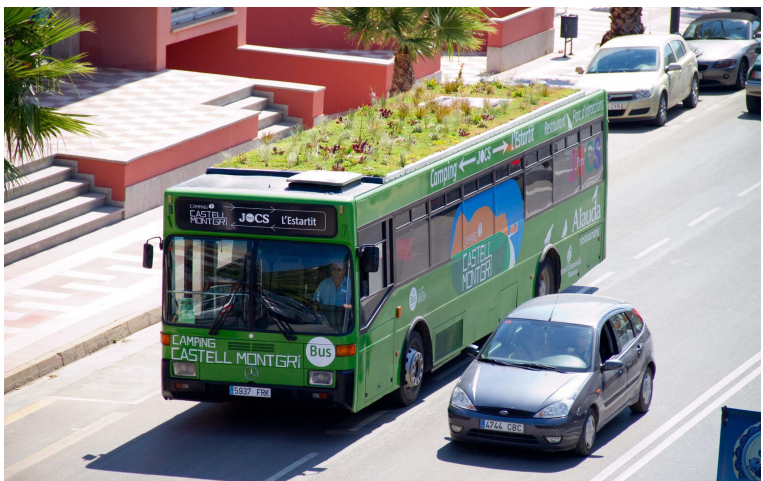
Figura 4.17. Cubierta ajardinada ligera en la cubierta de un autobús, empleando lana de roca.
