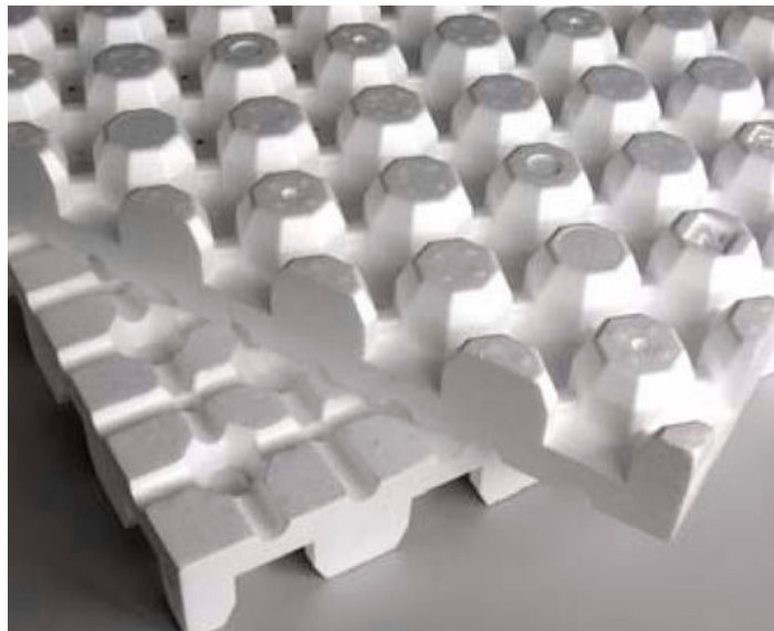
Figura 4.20. Panel rígido de EPS, de espesor aproximado 75 mm: colocación inferior para retención de agua (capacidad de retención de agua de 3 L/m 2 ) o colocación superior en cubiertas inclinadas.
