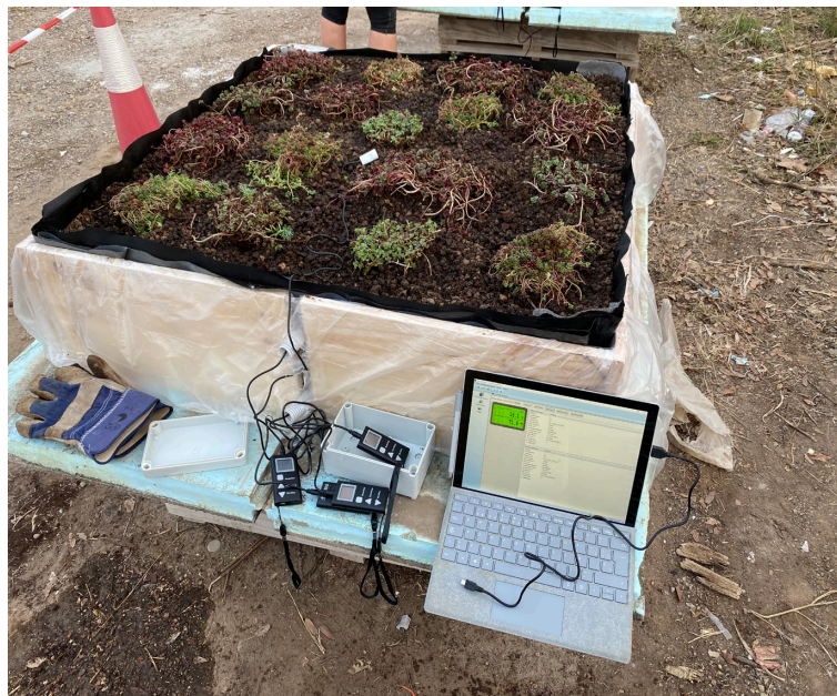
Figura 6.25. Agrupación de data-loggers en caja lateral, facilitando la toma de datos.
