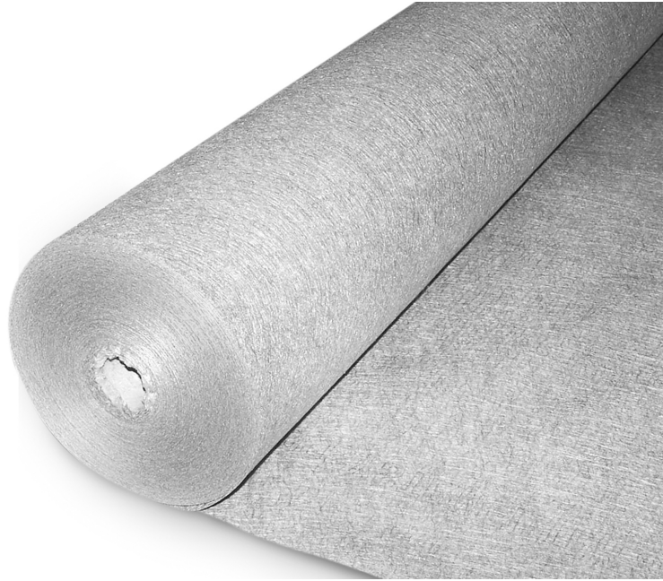
Figura 4.22. Lámina filtrante de polipropileno, O_{90} 95 \mu\text{m} y una densidad de 100 \text{gr}/\text{m}^2 .
