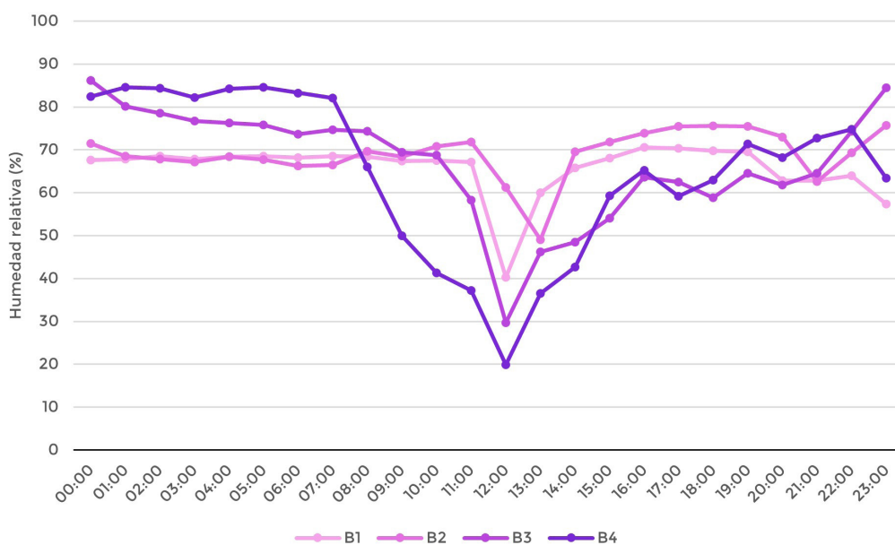
Figura 6.52. Humedad relativa (%) por horas de las sondas de la maqueta B para el día 12 de julio de 2021.
