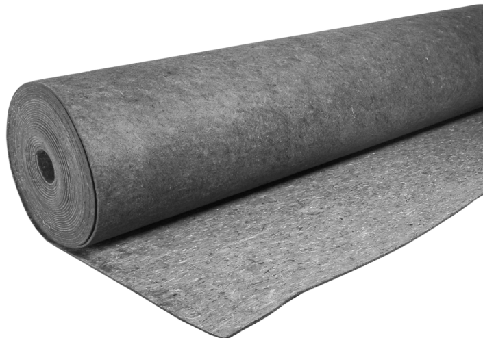
Figura 4.19. Capa retenedora de agua de fibras de poliéster/polipropileno, de espesor aproximado 6 mm y una capacidad de retención de agua de 4 L/m 2 .
