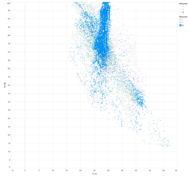
Figura 6.39. Diagrama de dispersión con la distribución de los datos por humedad relativa (%) y temperatura (°C) por maqueta para el mes de julio.
