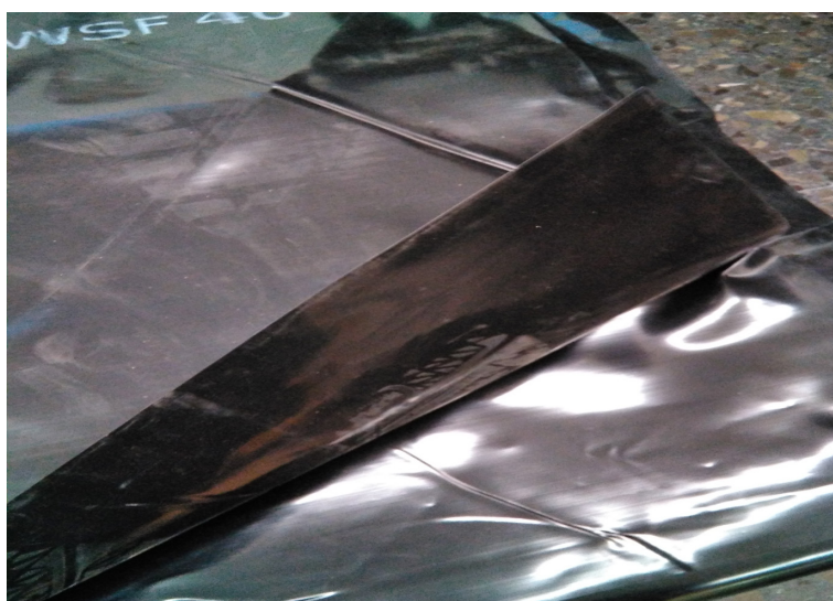
Figura 4.12. Lámina antiraíces de polietileno, espesor aproximado de 0,34 mm y masa de 320 gr/m 2 .
