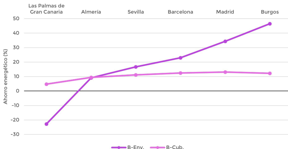
Figura 7.11. Porcentaje (%) de ahorro energético respecto al consumo de energía final anual del modelo de referencia para el modelo B y en los dos casos de rehabilitación: toda la envolvente (Env.) y solo cubierta (Cub.).
