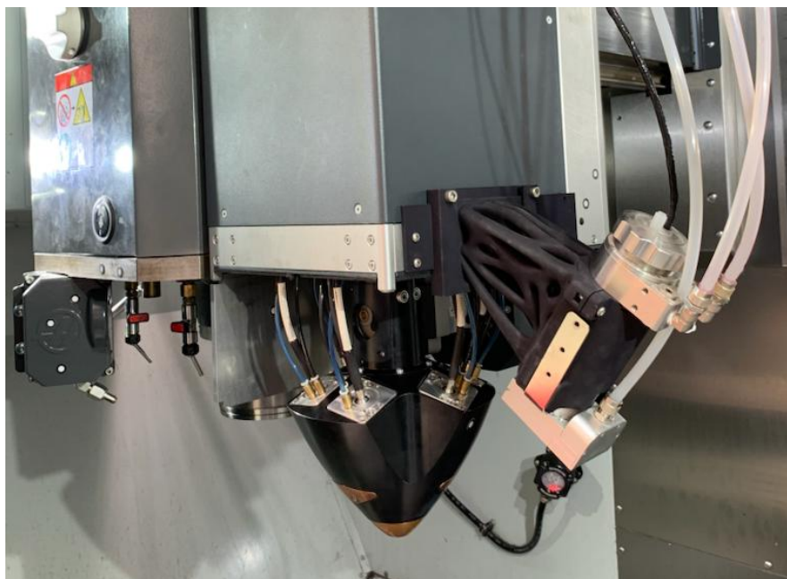
Figura 57. Incorporación del sistema termográfico .
