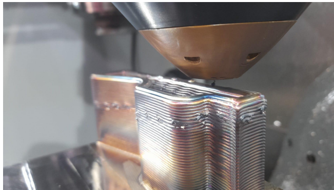
Figura 3. deposición de material (Parte aditiva)
