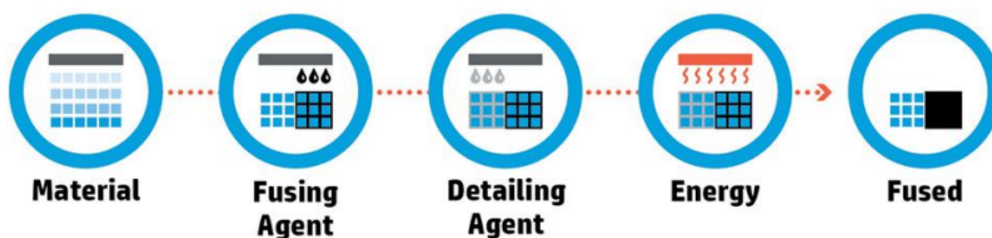
Figura 16. Proceso de fabricación de HP Multi Jet Fusion. Fuente: HP
