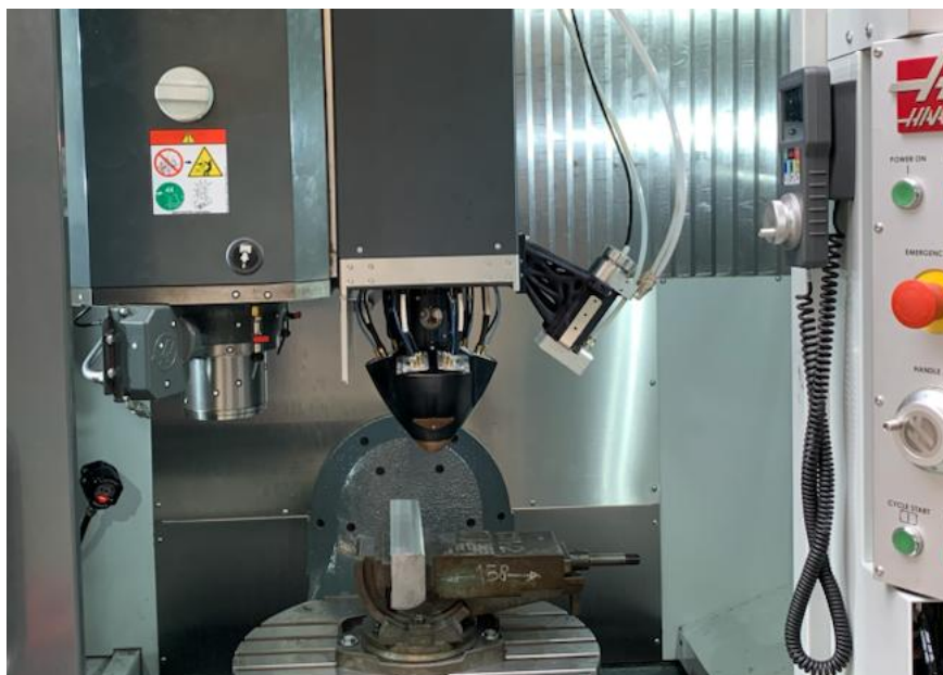
Figura 58. Incorporación del sistema termográfico .
