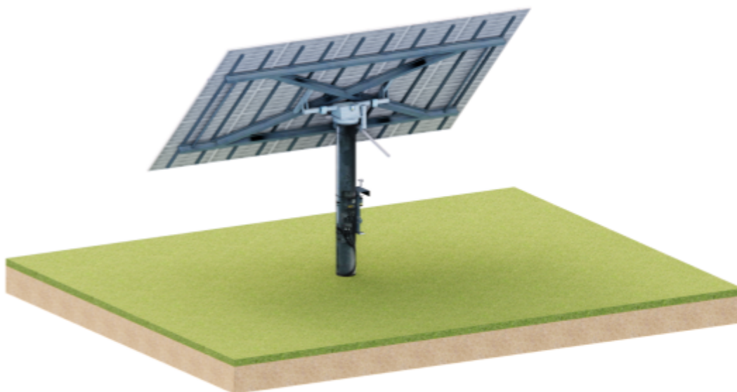
Figura 6. Estructura Tracker (Seguidor solar). Fuente: Elaboración propia.
