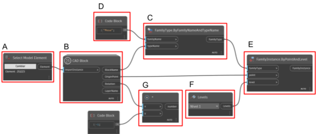
Figura 47. Programación para localización de la familia “Mesa” en el layout. Fuente: Elaboración propia.
