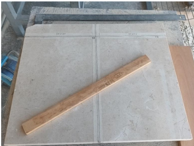
Figura 71: Marcado de las líneas de corte sobre el mármol. 2023.
