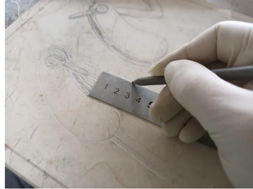
Figura 76: Marcado del dibujo con punta de acero. 2023.
