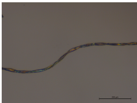
Fig. 14. Fibra del soporte textil observada con un microscopio Leica MC170 HD a 10 mp.
