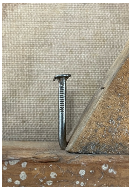
Fig. 47. Clavo limpio y protegido con Paraloid® B-44 al 7% en acetato de etilo.
