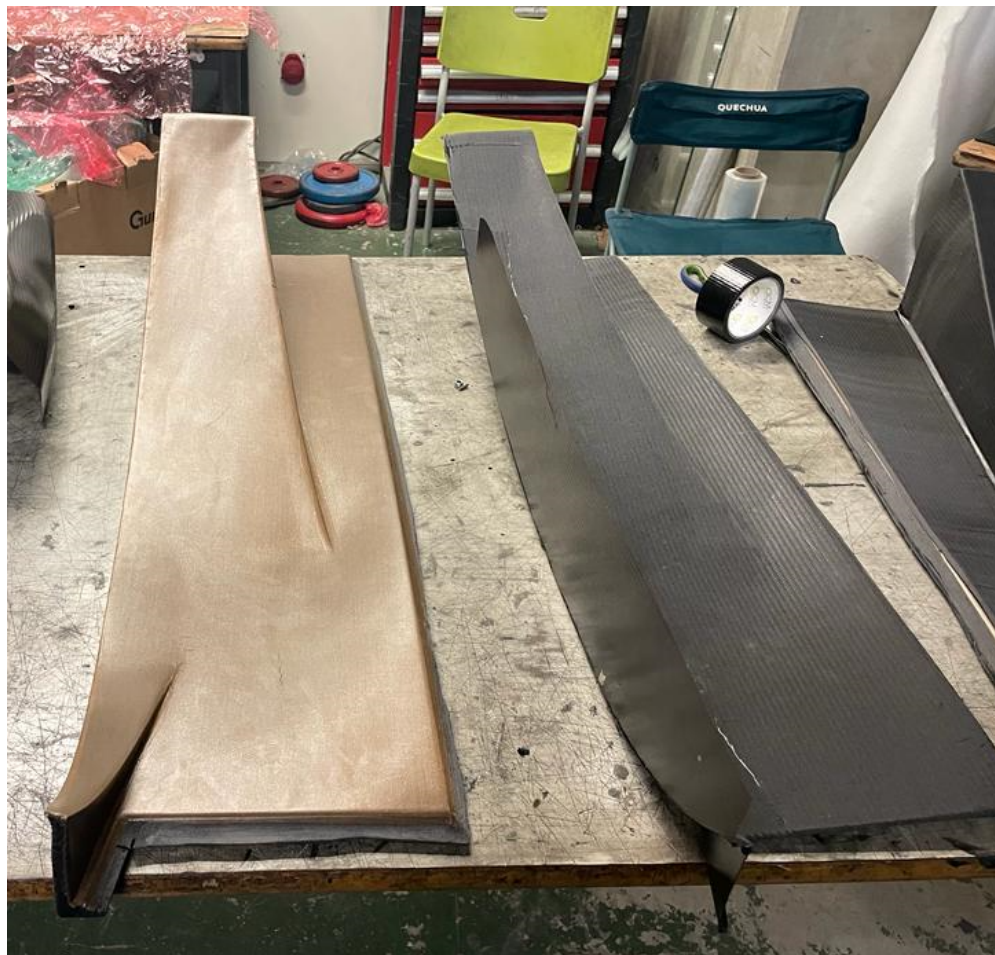
Figura 5.12: Paquete aerodinámico lateral del FSUPV-09 molde y pieza en fibra de carbono.
