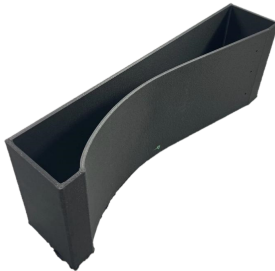
Figura 4.14: Producto final del proceso de fabricación aditiva (AM) mediante el proceso FDM para la fabricación del molde.
