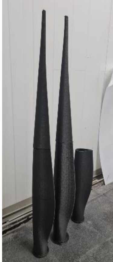
Figura 5.9: Fabricación de palas de aerogenerador a escala y su proceso de impresión 2
