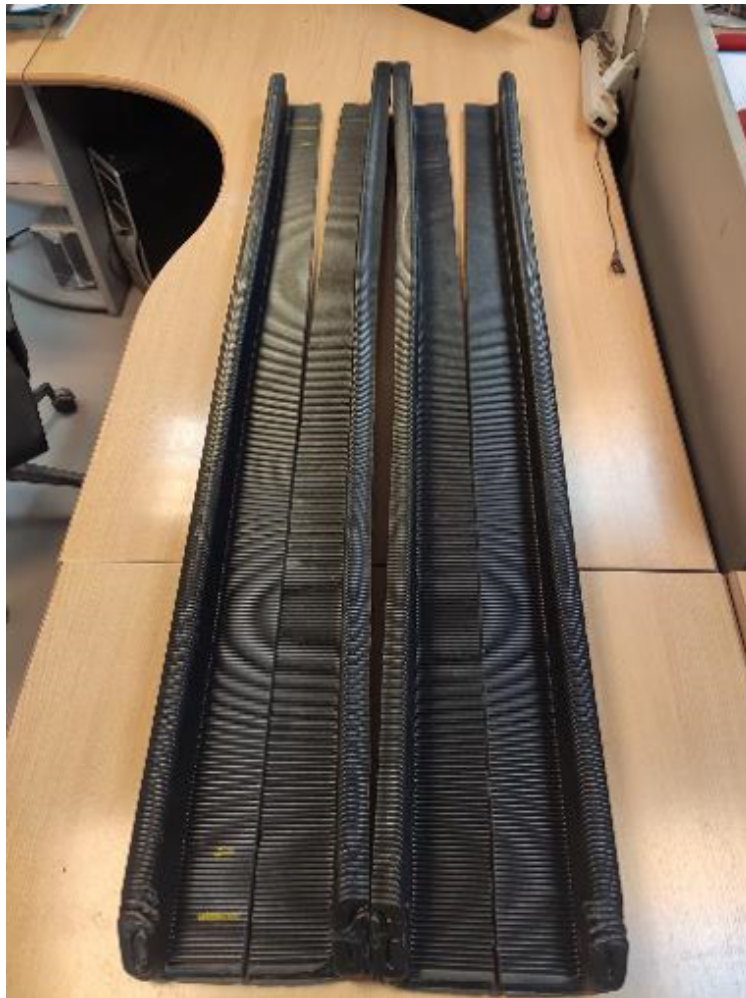
Figura 5.19: Efecto warpage en el centro de las piezas.
