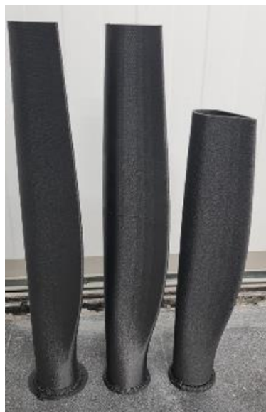
Figura 5.10: Fabricación de palas de aerogenerador a escala y su proceso de impresión 3
