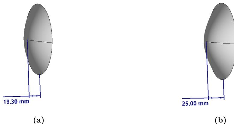
Figura 5.14: (a) Lentes diseñadas de 19.3 mm y (b) 25 mm.
