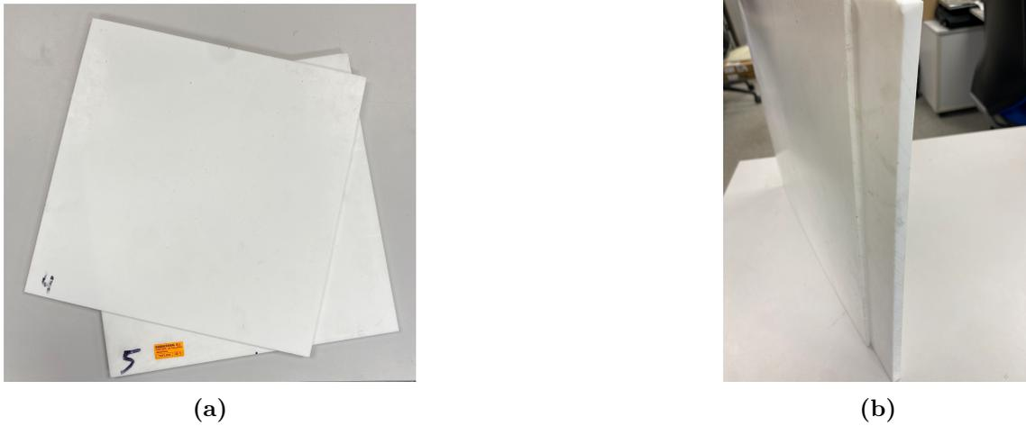
**Figura 4.8: Muestras de Teflón (PTFE) de 5 mm y 10 mm.**
