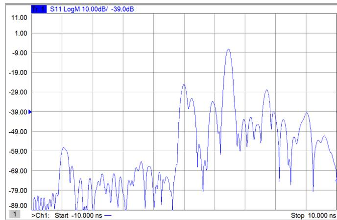
Figura 4.20: Captura obtenida del VNA midiendo el parámetro  $S_{11}$  con la placa de metal entre las antenas.
