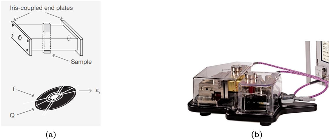
Figura 2.3: (a) Esquema del método de medida con cavidad resonante [11], y (b) montaje real cavidad resonante [11].
