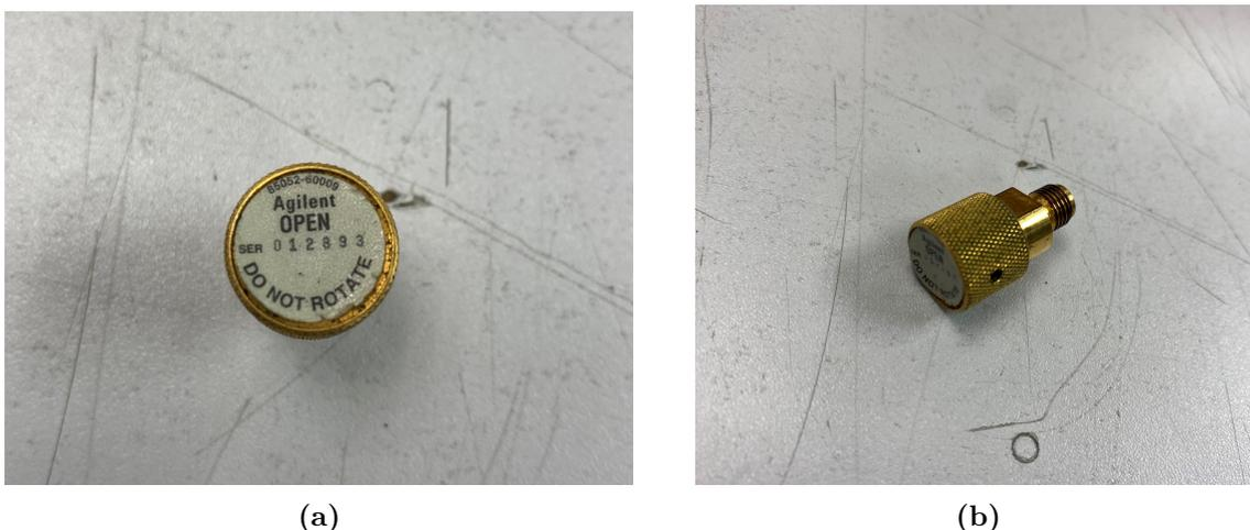
Figura 4.12: Terminación de “circuito abierto” de 3,5mm.
