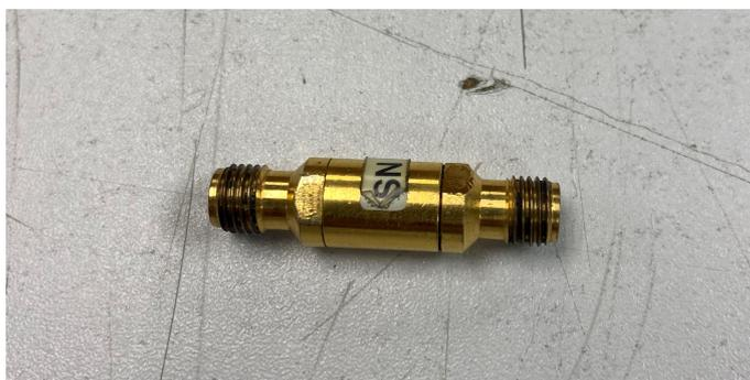
Figura 4.14: Conexión hembra-hembra para el estándar “*Thru*” de 3.5 mm.
