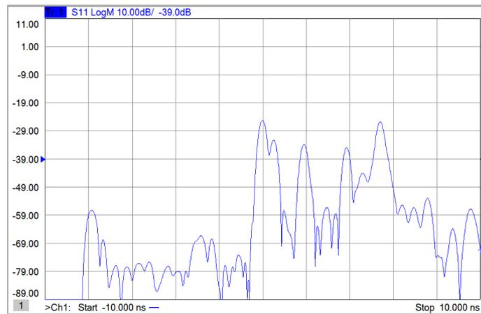
Figura 4.19: Captura obtenida del VNA midiendo el parámetro  $S_{11}$  con visión directa entre las antenas.
