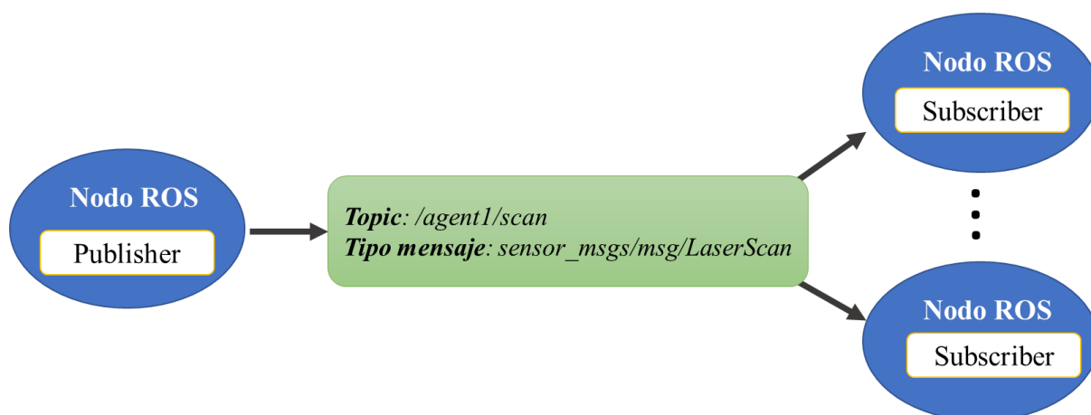
Figura 12 Funcionamiento de la comunicación en ROS mediante topics entre Publisher y Subscriber.
