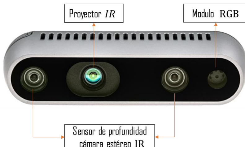
Figura 20 Componentes de la cámara RealSense D435
