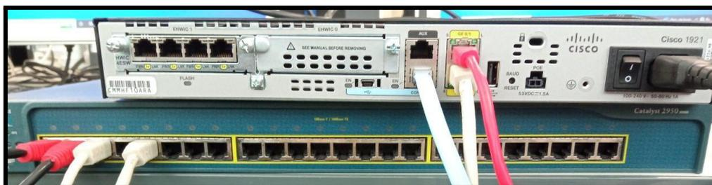
Figura 74. Montaje de la topología de red.
