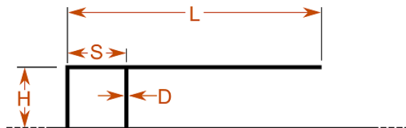
Figura 2.16: Esquema de una antena IFA de longitud L , altura H , espaciado de alimentación S y diámetro D sobre un plano de masa. Captura del modelo en Antenna Magus.
