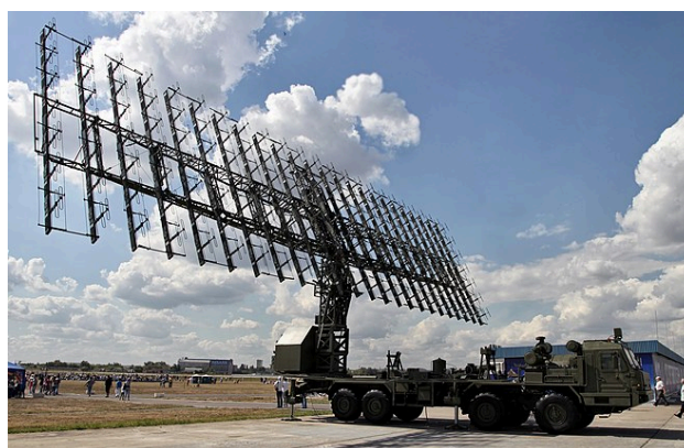
Figura 1.2: Array de elementos con apuntamiento mecánico para uso militar
