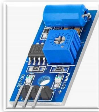
Figura 15. Imagen del sensor SW420
