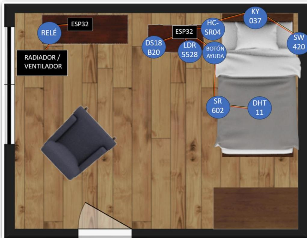
Figura 17. Esquema de la distribución de los sensores del sistema
