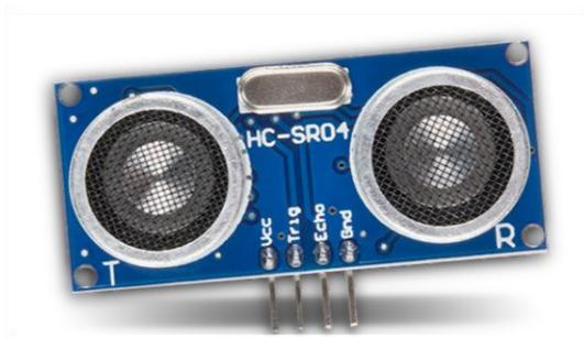
Figura 9. Imagen del sensor HC-SR04
