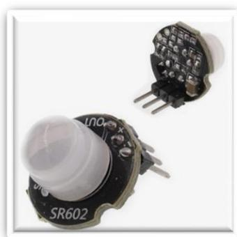
Figura 10. Imagen del sensor SR602
