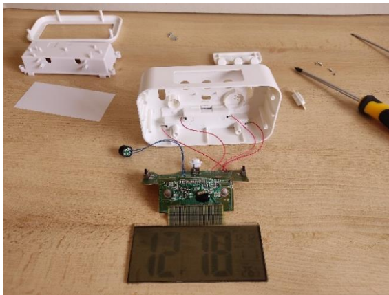
Figura 83. Desmontaje del despertador “LCD Clock”
