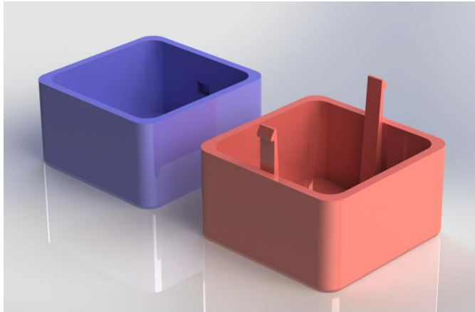
Figura 79. Ejemplo de unión gancho-ranura
