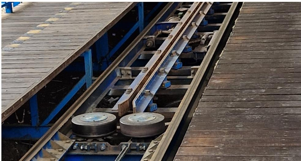
Figura 12: Neumáticos de impulsión o compresión y frenos de aleta
