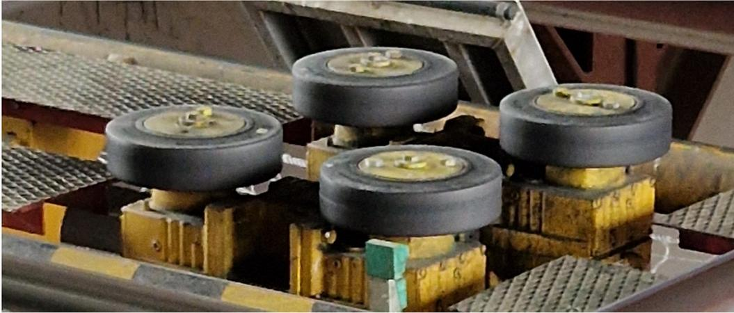
Figura 11: Neumáticos de impulsión o compresión
