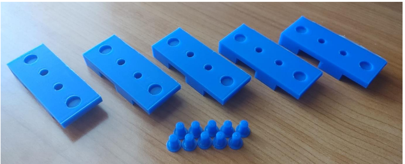
Ilustración 31 Piezas de PLA hechas por Impresión 3D. Elaboración propia.
