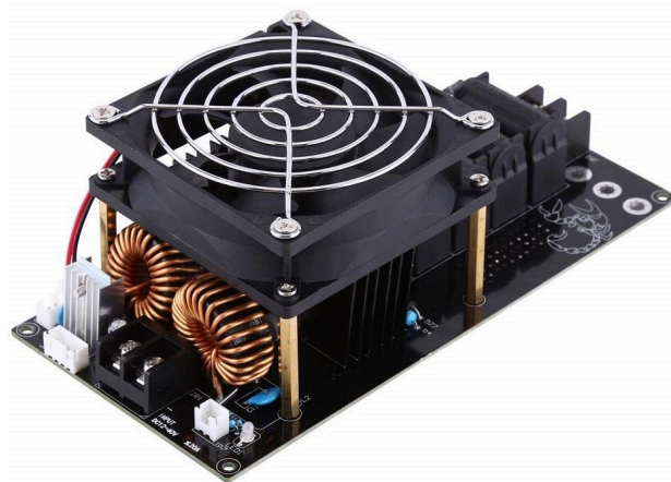
Fig. 1.28. Módulo de calentamiento por inducción ZVS (12-36 V CC, 20 A, 1000 W).
