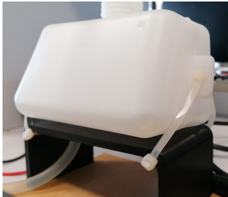
Fig. 3.3. Colocación del depósito sobre el soporte diseñado.
