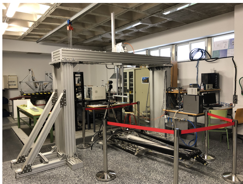
Figura 5: Banco de ensayos con el accionamiento vertical. Fuente: propia
