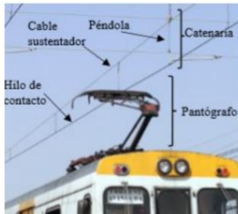
Figura 1: Principales elementos de la generación de energía eléctrica entre la catenaria y el pantógrafo. Fuente: [1]
