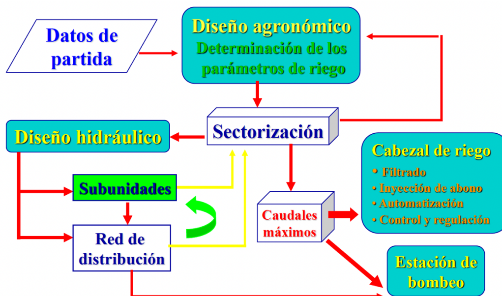
Ilustración 1. Fases del diseño de un sistema de riego localizado. Fuente: apuntes de la asignatura de Ingeniería hidráulica del máster MUIA (Máster Universitario de Ingeniería Agronómica)
