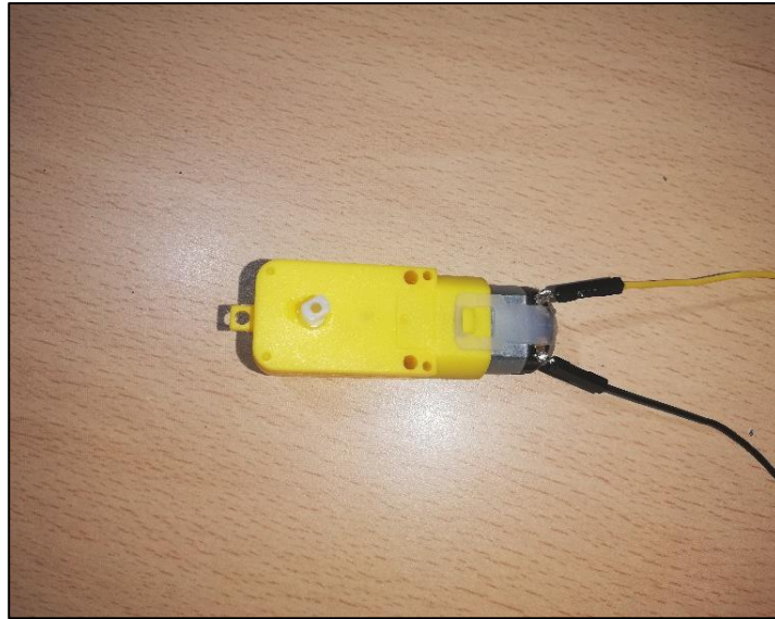
Figura 31. Motor DC con el cableado soldado
