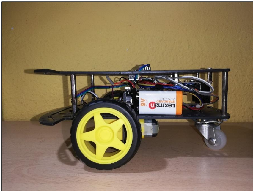
Fig. 39. Colocación de la electrónica (visión lateral)
