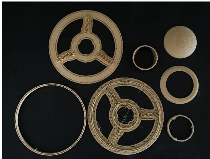
*Nota:* Secciones de impresiones fallidas con materia de concha triturada.
