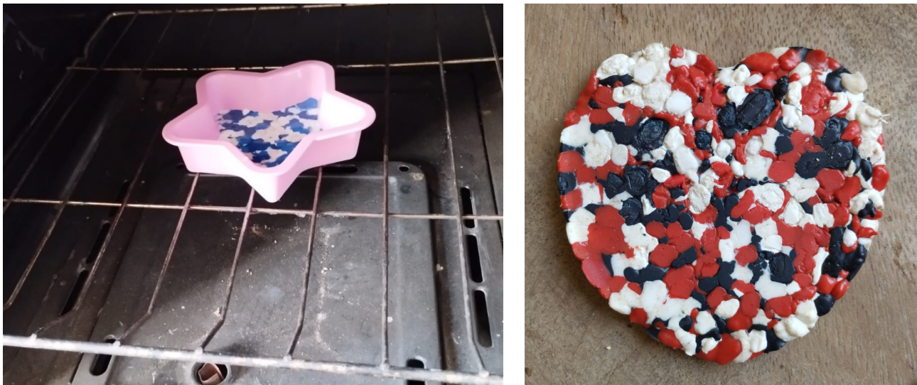
Figura 199. Corrección de los fallos en el posavasos de corazón [Fotografía]. Ferrando, L. (2023).
