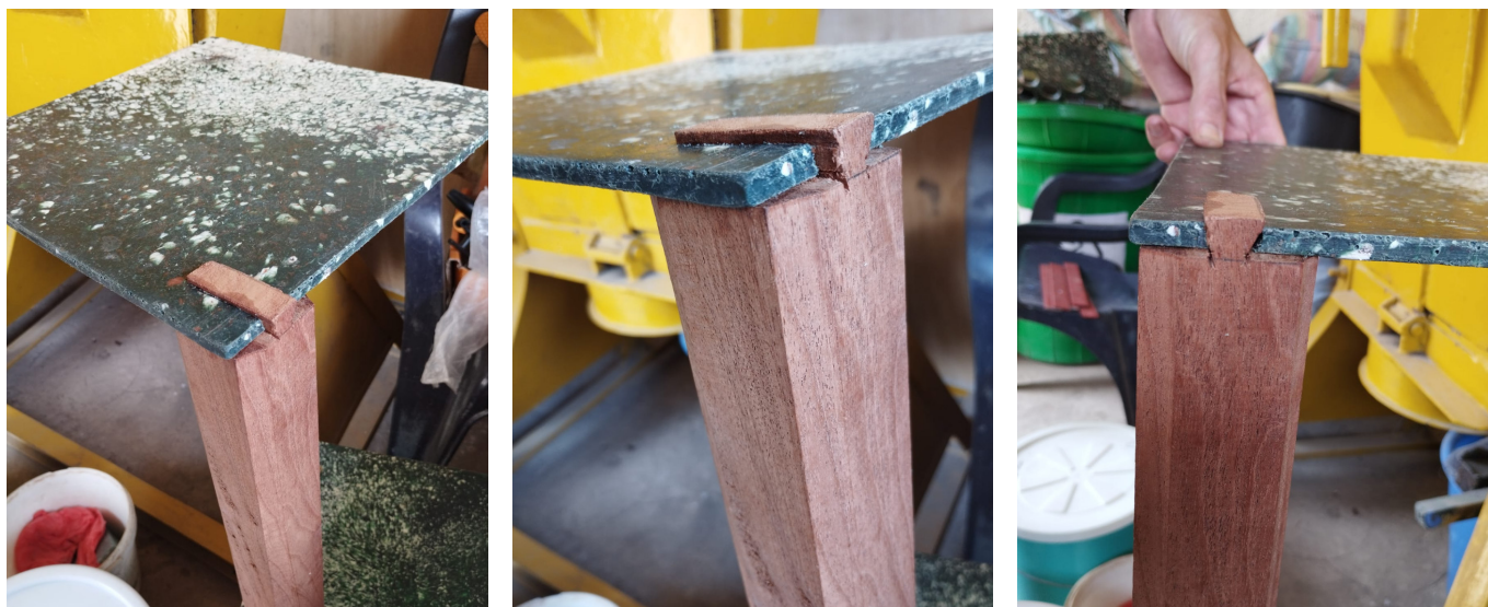
Figura 216. Pruebas del encaje de cola de milano. [Fotografía]. Ferrando, L. (2023).
