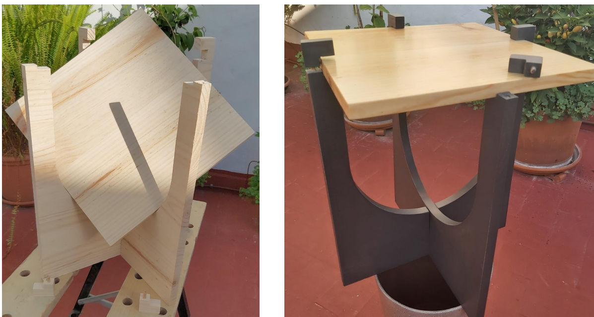
Figura 218. Solución para el encaje del tablero y las patas (taburete 2). [Imagen]. Ferrando, L. (2023).
