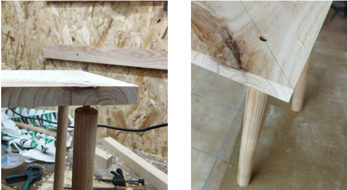
Figura 219. Prototipos del primer modelo de patas (taburete 3). [Imagen]. Ferrando, L. (2023).
