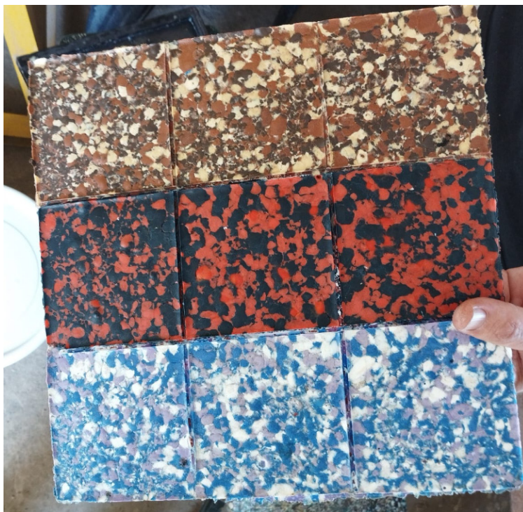
Figura 196. Resultado del fundido de plástico para los posavasos cuadrados [Fotografía]. Ferrando, L. (2023).
