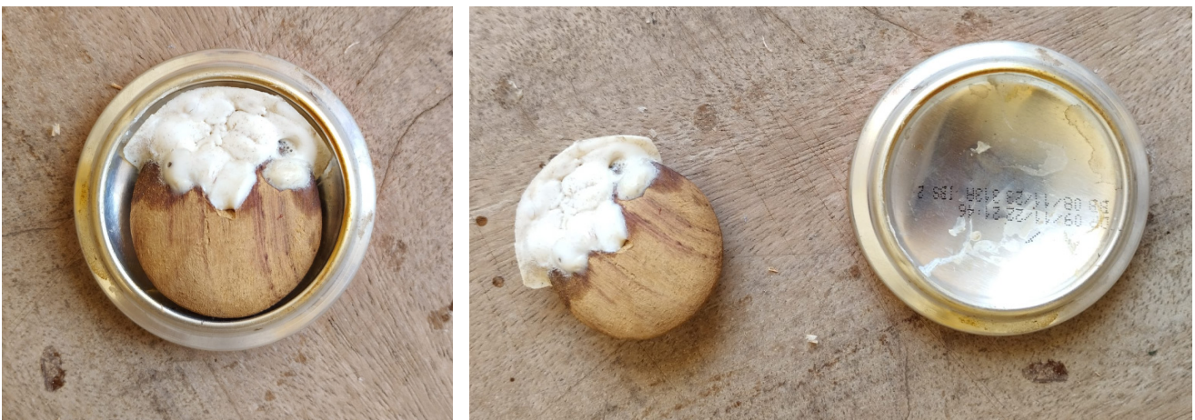
Figura 230. Pruebas de fundido de plástico en los collares de madera. [Fotografía]. Ferrando, L. (2023).
