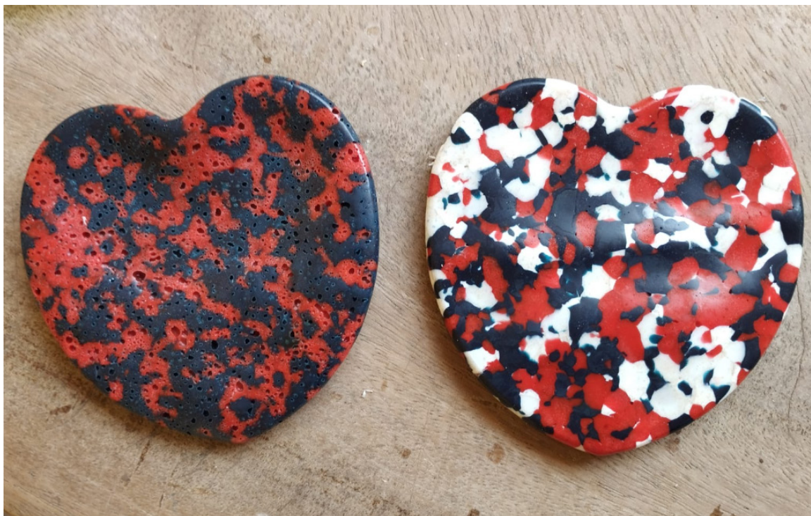
Figura 200. Comparativa entre la corrección y los fallos en el posavasos de corazón.[Fotografía]. Ferrando, L. (2023).
