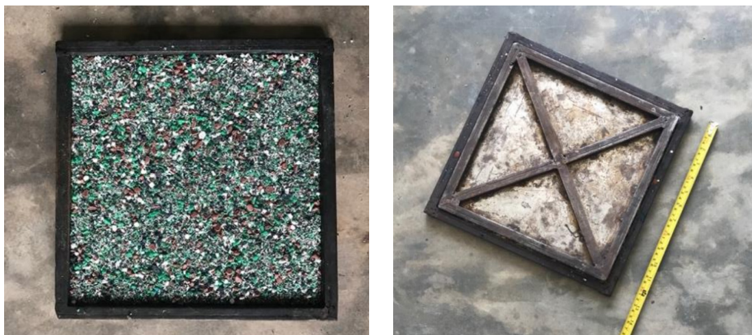
Figura 212. Molde cuadrado para las planchas de plástico. [Fotografía]. Tovar. L. (2022).
