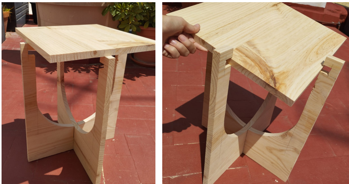
Figura 217. Pruebas del encaje del tablero y las patas. [Imagen]. Ferrando, L. (2023).
