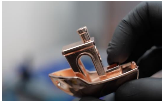
Figura 38. Electroplating con capa de cobre. Fuente: HEN3DRIK
