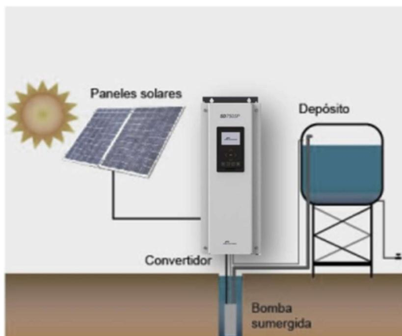
Ilustración 6. Esquema de la instalación de bombeo solar. Fuente: POWER ELECTRONICS.
