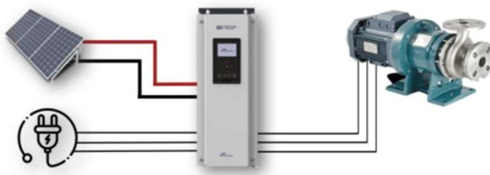
Ilustración 9. Esquema de funcionamiento híbrido del variador. Fuente: POWER ELECTRONICS.
