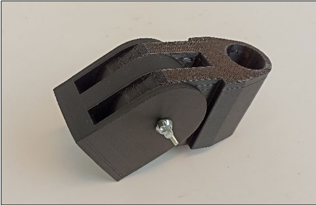
Figura 33. Prototipo v3 modelo impreso en PLA.
