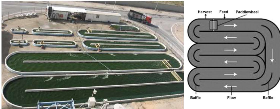
Figura 1.24. Sistema abierto tipo raceway para el cultivo de microalgas ( https://www.earthrise.com ; Bahadar & Bilal Khan, 2013).
