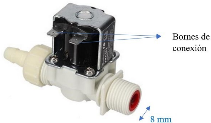
Figura 10 – Imagen de una electroválvula de la marca Velleman. Se indican sus bornes de conexión, así como el diámetro que tienen el orificio de salida y entrada de agua del componente. En el orificio izquierdo está instalada una boquilla adaptadora que reduce el tamaño de entrada.
