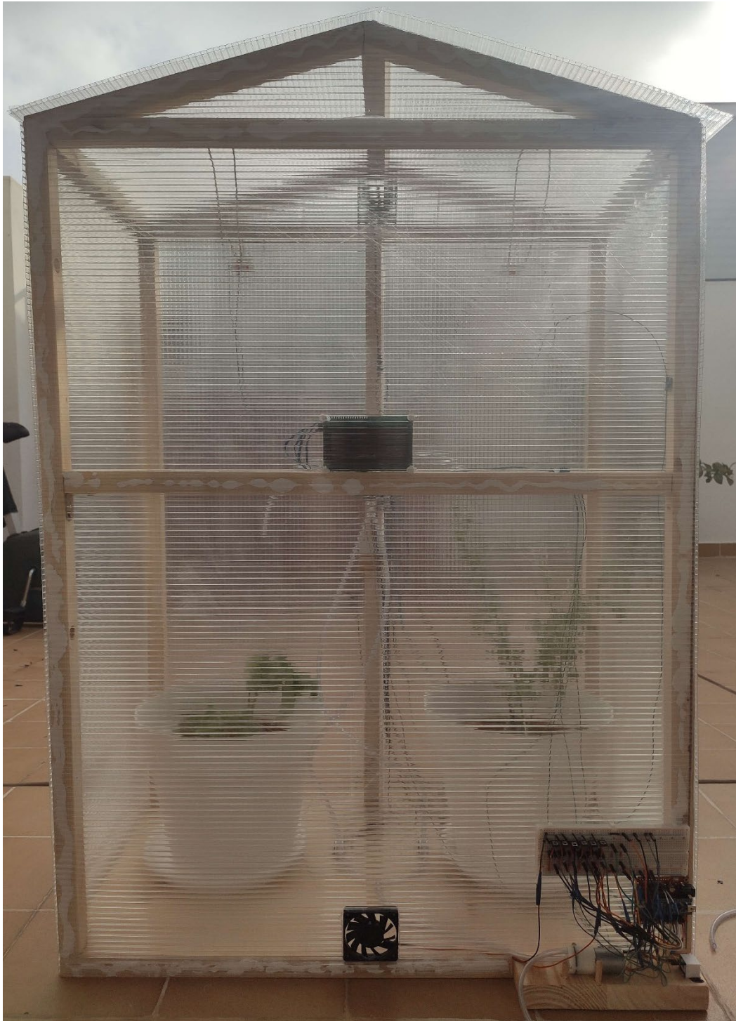
Figura 37 – Montaje realizado de la maqueta de invernadero. Se observan las dos plantas en el interior y todo el circuito electrónico en la parte exterior derecha, donde falta una cobertura para la protección contra la lluvia.
