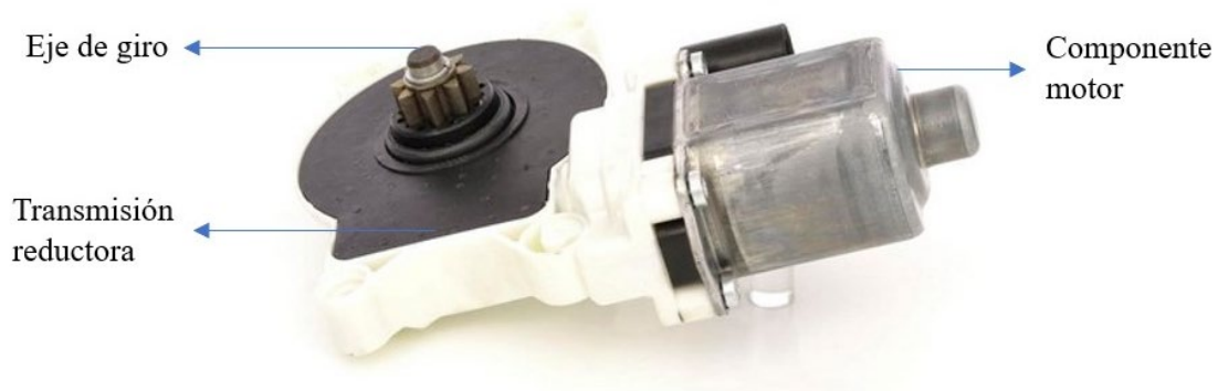
Figura 12 – Imagen de un motorreductor, compuesto por dos partes. La parte derecha es la parte motorizada, que genera el giro con un determinado par y una determinada velocidad. La parte izquierda, la transmisión reductora, reduce la velocidad de giro aumentando el par del componente. Las condiciones finales se dan a partir del eje de giro.
