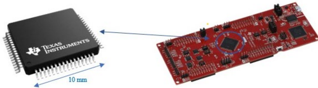
Figura 2 – Dimensiones de un F280049C, de la marca Texas Instruments. Se indica su posición en un circuito embebido, en este caso una placa de desarrollo creada para la facilidad del uso del microchip en cuestión.
