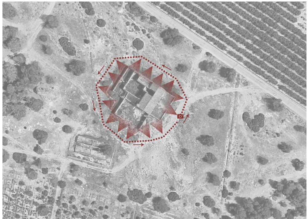
Figura 70: Esquema de la toma de datos en fotogrametría. Elaboración propia.
