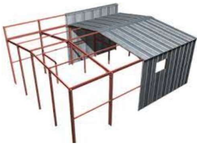
Imagen 26: disposición de cerramientos
