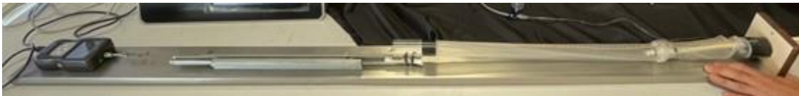
Figura 14. Imagen del montaje del intestino artificial lineal. Se puede observar el dinamómetro digital, los soportes y el propio intestino.
