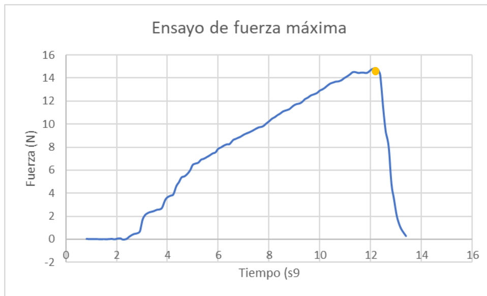
Figura 29. Representación de los valores de fuerza registrados por el dinamómetro durante el ensayo para la obtención de la fuerza máxima. En concreto la M4 a volumen de 20mL sin lubricante. El valor de fuerza máxima es representado con un punto amarillo.
