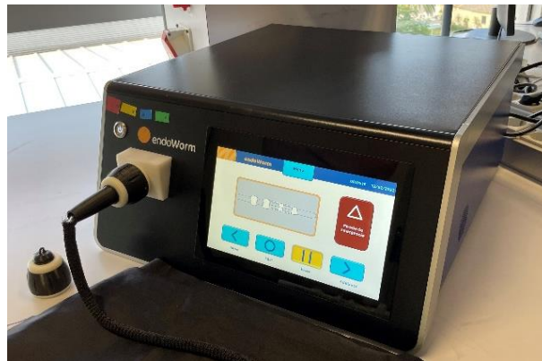
Figura 8. Dispositivo de control del sistema Endoworm. Se puede observar su panel de control y la conexión de las vías de alimentación de aire de la sonda enteroscópica.
