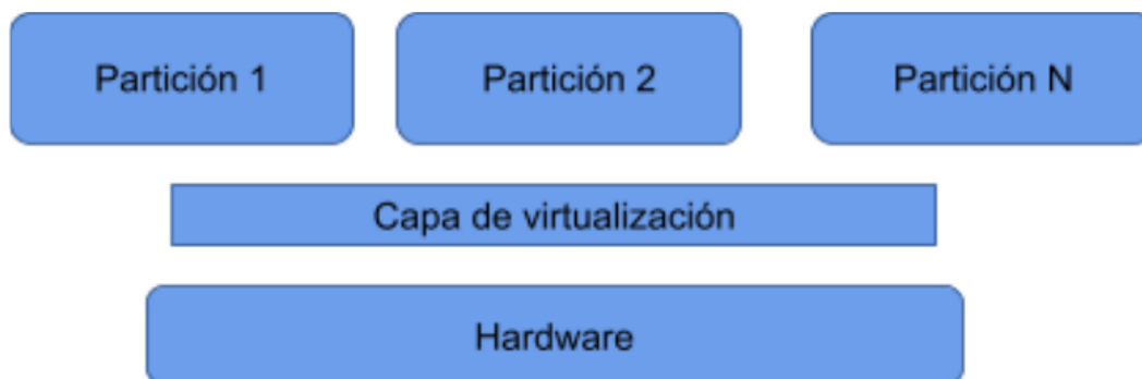
Figura 4.1: Arquitectura de un sistema particionado
