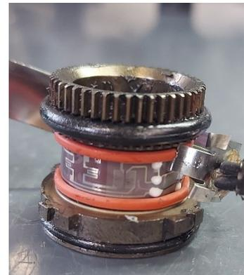
Figura 6 – Transductor de par
