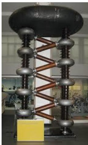
**Imagen 3.** *Generador de alto potencial eléctrico en cascada de Cockcroft-Walton (Jimeno, Presente, pasado y futuro de los aceleradores de partículas (Parte 1), 2020).*
