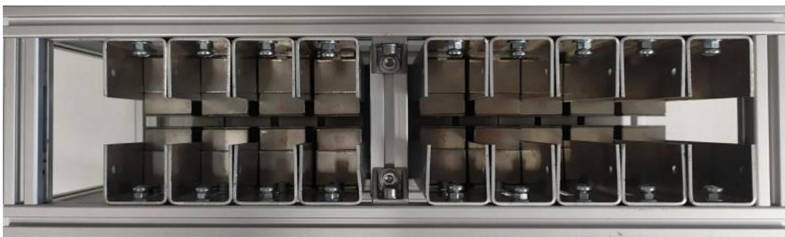
**Imagen 26.** Selector energético de protones con los pilares introducidos.
