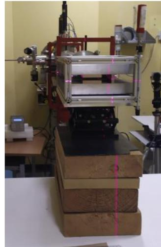
**Imagen 71.** Seleccionador nivelado y orientado correctamente delante de la fuente de protones.
