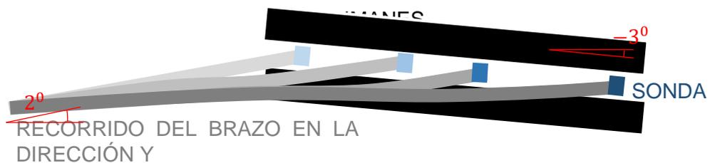
**Imagen 42.** Representación del recorrido de la sonda a través de la dirección del eje Y de la superficie a medir.
